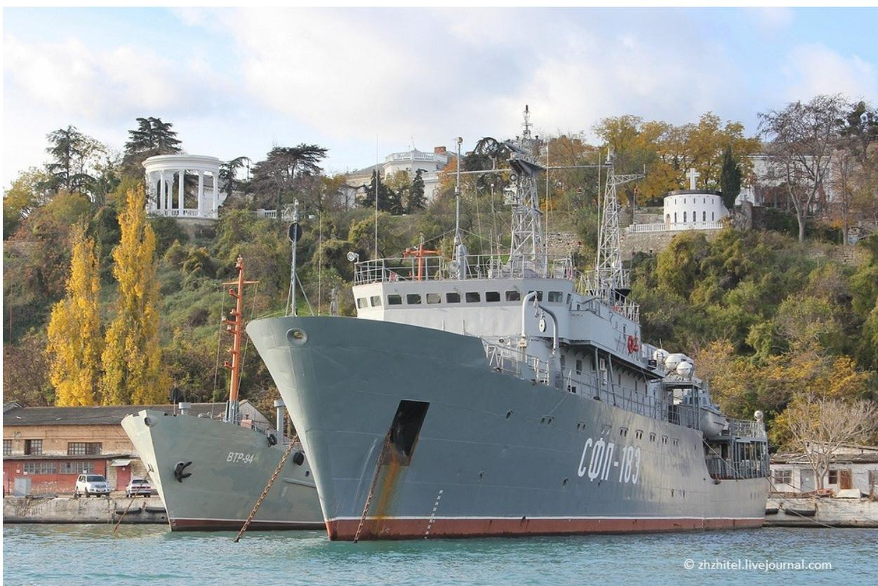
28. ВТР-94 — морской транспорт вооружений проекта 1823 предназначен для транспортировки, хранения и передачи на плаву или у причальных сооружений торпедного боезапаса боевым кораблям различного класса.
