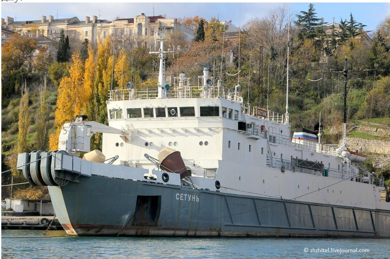
25. СР-26 — еще одно судно размагничивания.
